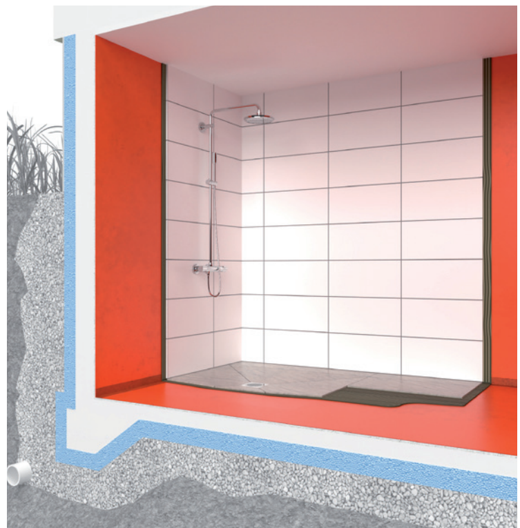
FIG. B – Kælder uden opstigende jordfugtighed
