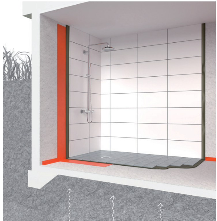
FIG. A – Kælder med opstigende jordfugtighed
