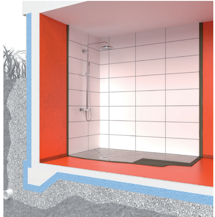
FIG. B – Kælder uden opstigende jordfugtighed
