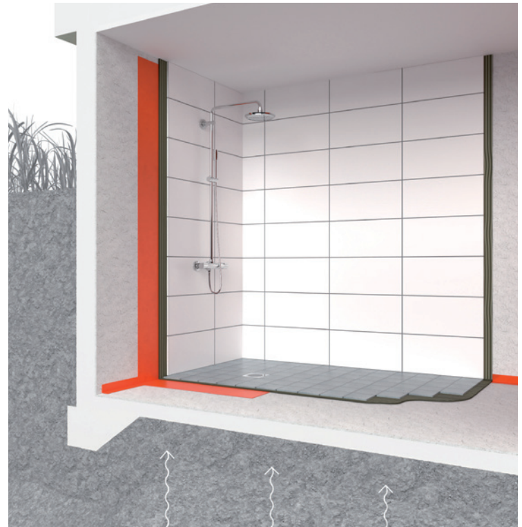
FIG. A – Kælder med opstigende jordfugtighed
